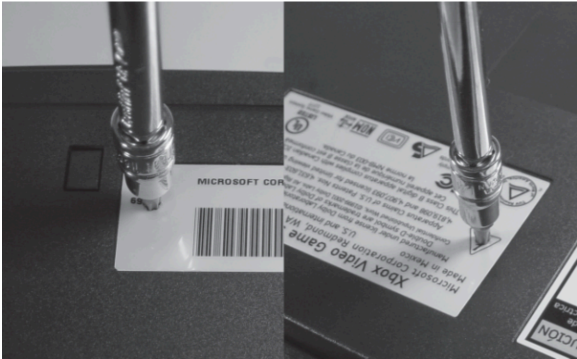
図 1-4: シリアル番号と製品認証ラベルに隠されたネジの位置。
