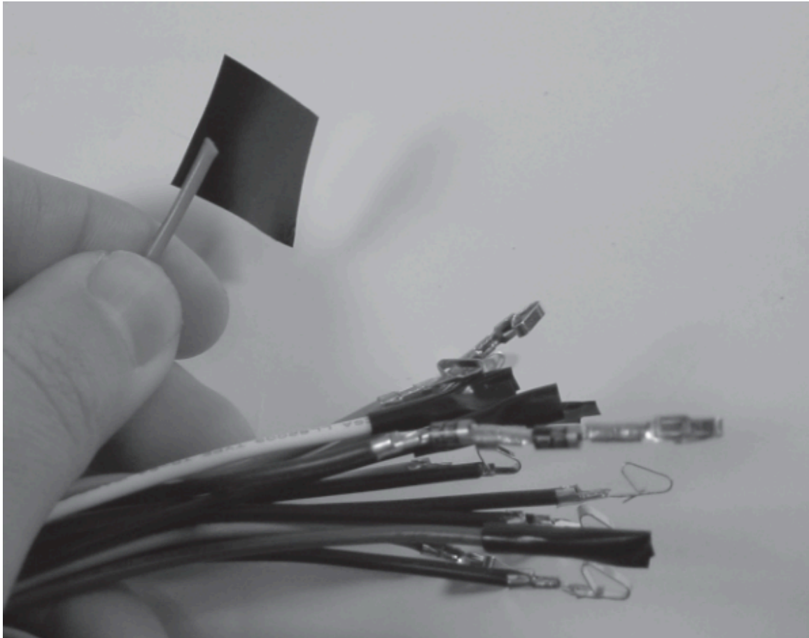
図 5-4: 未使用のワイヤーとダイオードを絶縁テープで巻いて偶発的な短絡を防ぐ。
