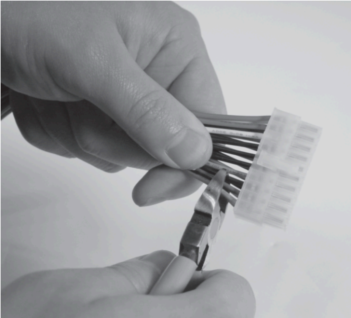
図 5-1: ATX 電源ケーブルのコネクタを切り取る。
