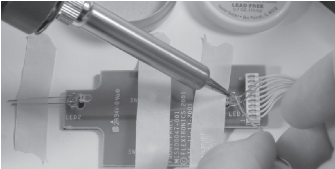
図 3-10: LED はんだ付けしている様子。基板と LED がマスキングテープで固定されていることに注目。
