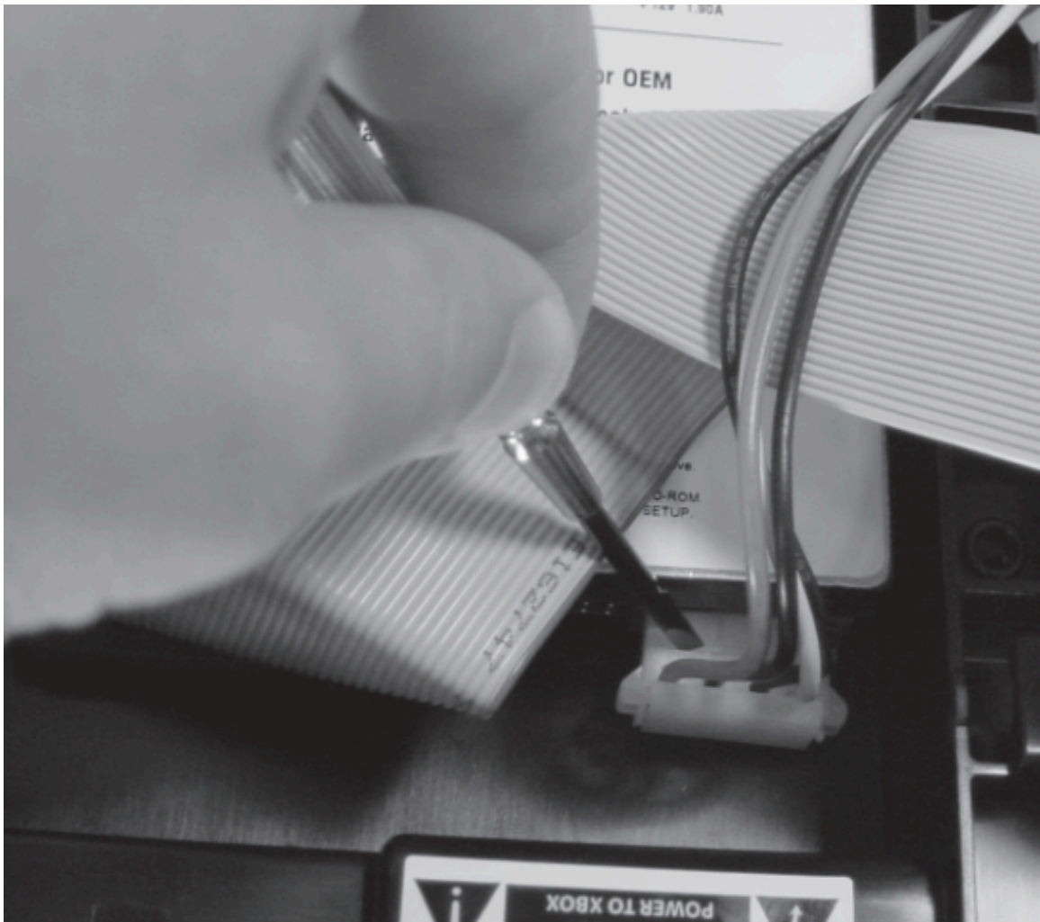
図 1-9: 平ドライバーでハードドライブの電源コネクタを取り外す様子。
