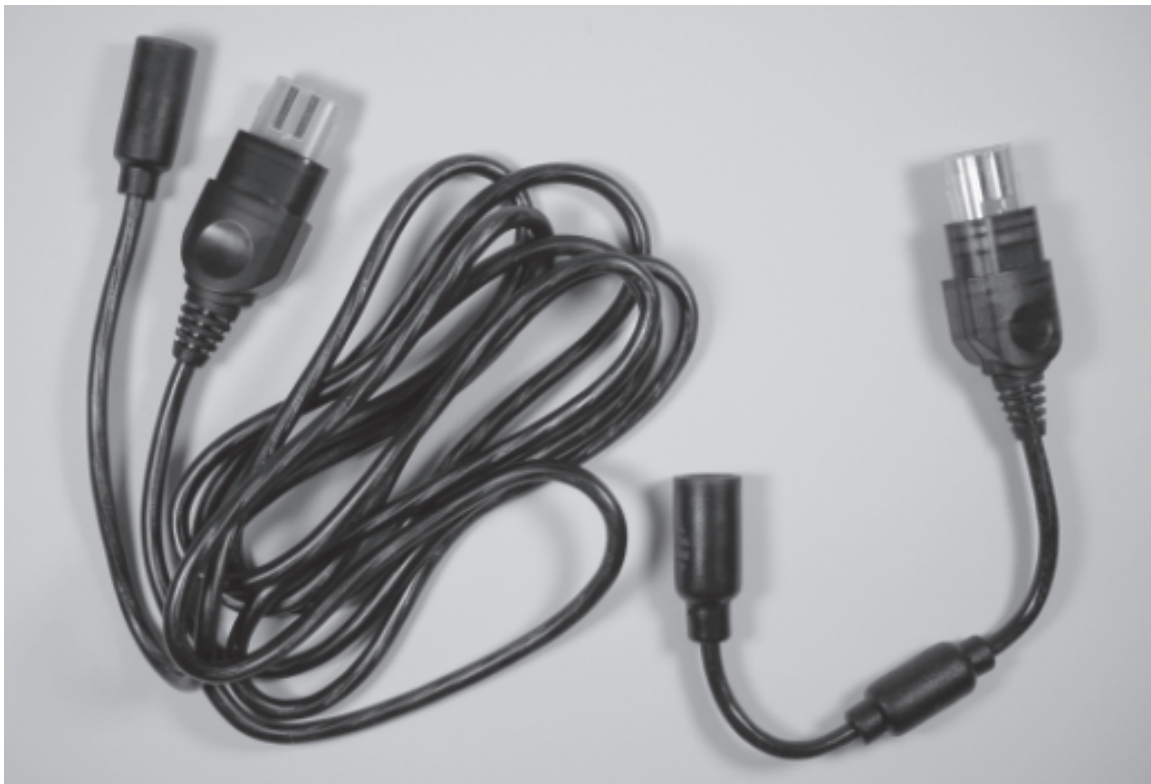
図 4-1: (左) Xbox ゲームコントローラー延長ケーブル。(右) Xbox ブレイクアウェイケーブル。
